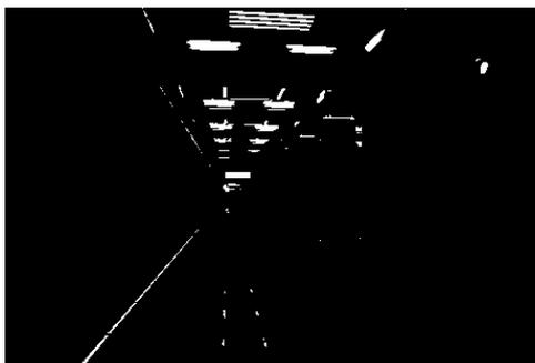
Рис. 8. Фотография станции Рассказовка и изображение пикселей, вошедших в расчёт UGR
