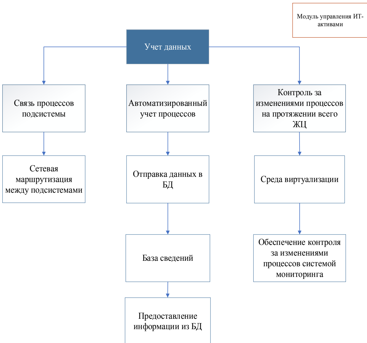
Рис.9. Функциональная модель модуля управления ИТ-активами
