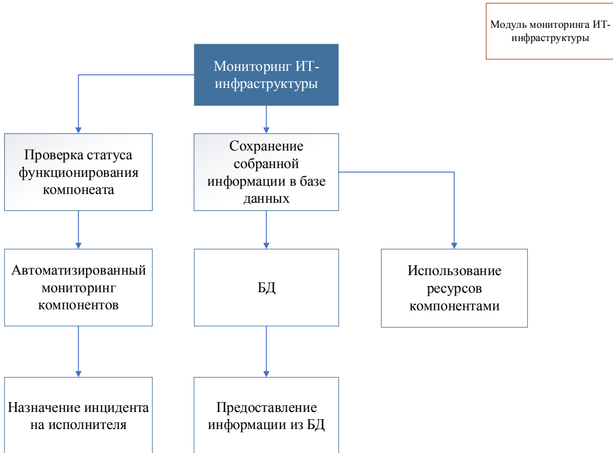
Рис.10. Функциональная модель Модуля мониторинга ИТ-инфраструктуры
